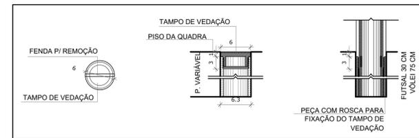
9 DETALHE FIXAÇÃO E TAMPO DAS TRAVES ESCALA 1/5
