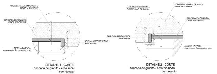
DETALHE 1 - CORTE bancada de granito - área seca sem escala
